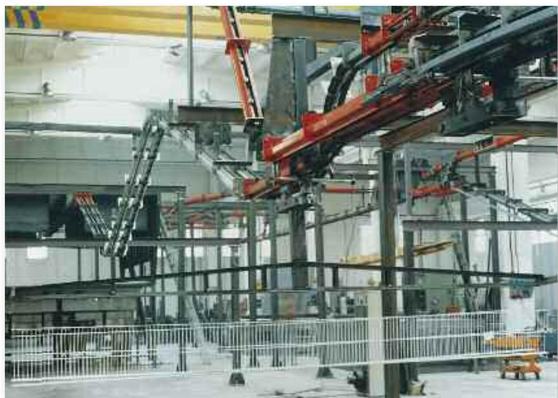
Particolare del sistema trasportatore di un impianto che riveste a letto fluido pezzi da 3600 mm di larghezza per una produzione di circa 3600 Kg/h installato negli U.S.A.
