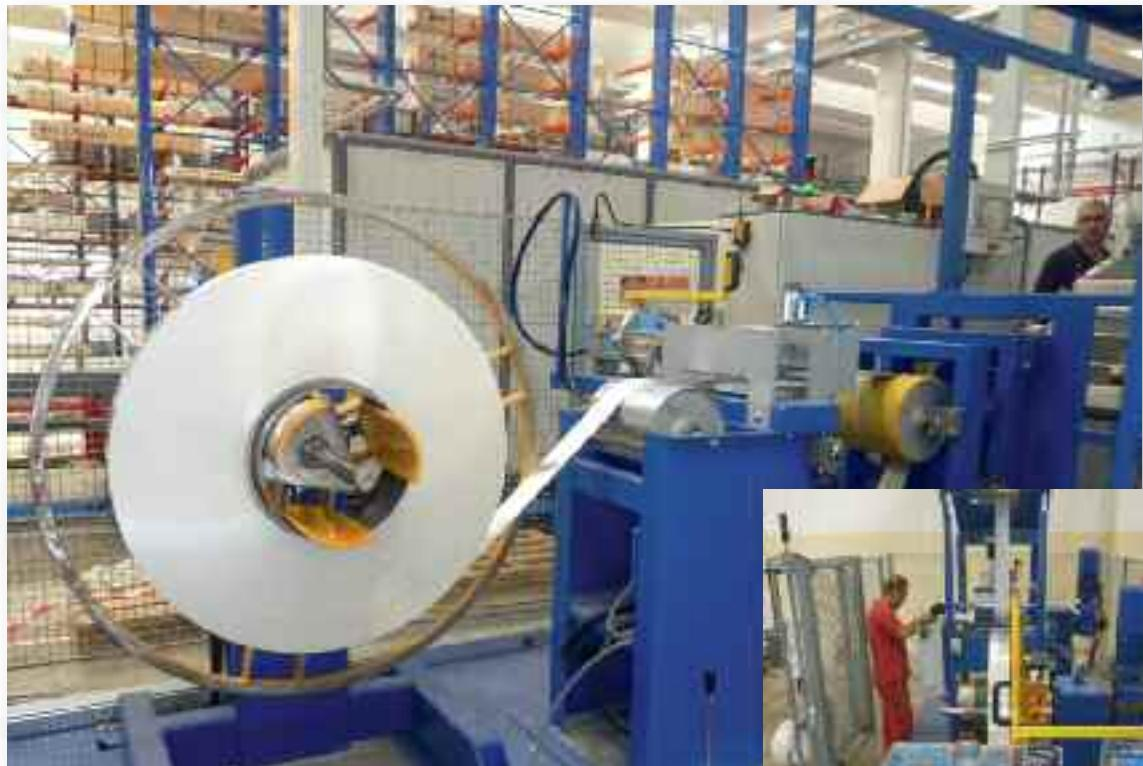
Impianto coil coating con applicazione flussante su nastri d'alluminio
