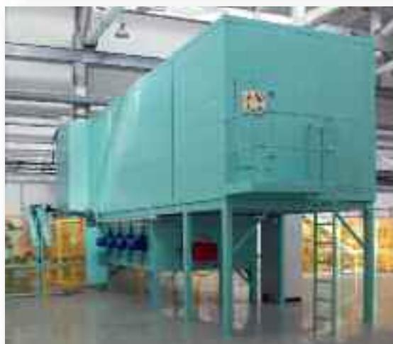
Forno cottura per particolari settore areonautico
