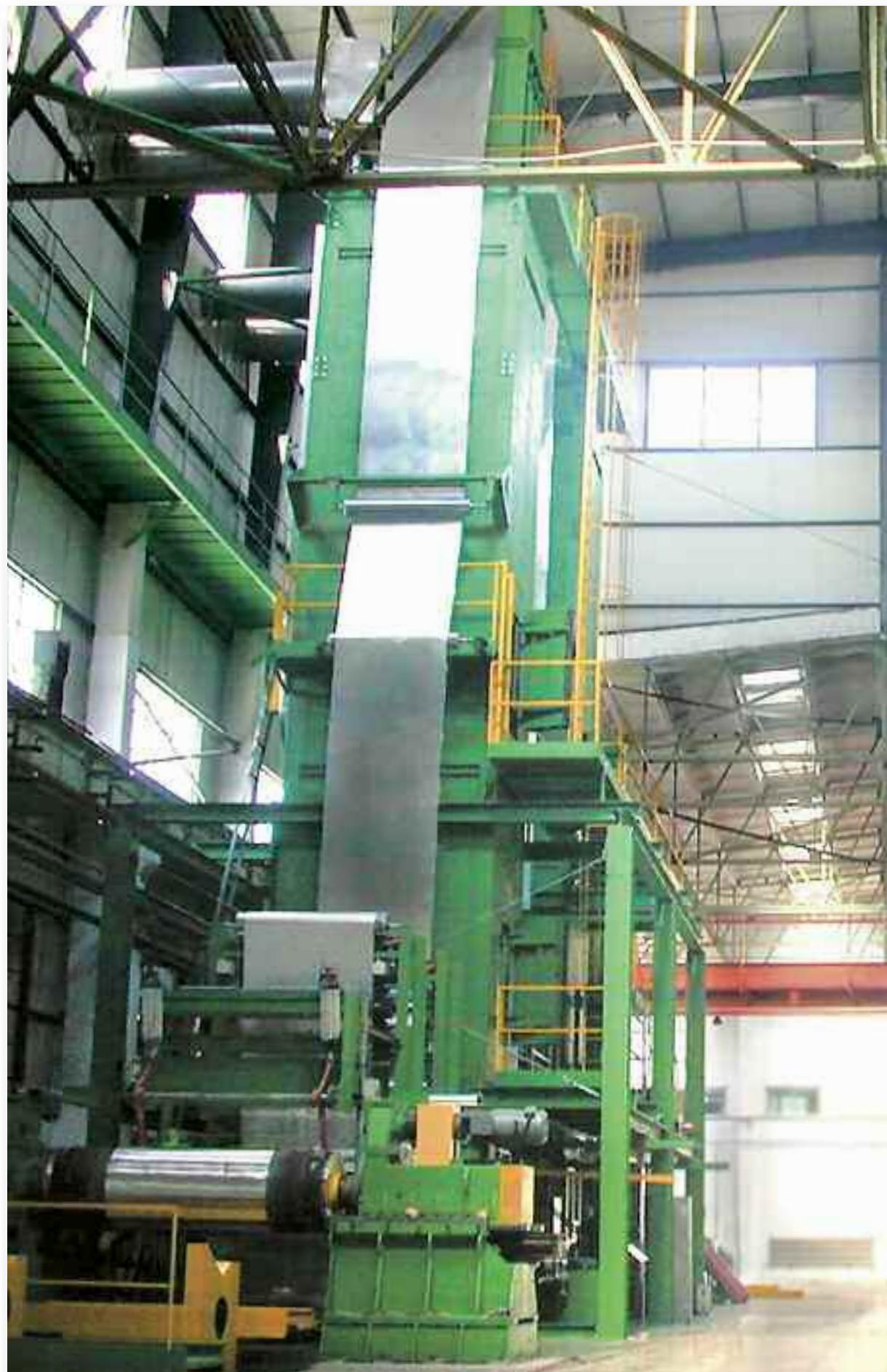
Impianto verticale per il trattamento della superficie di nastro alluminio "fin stock"
