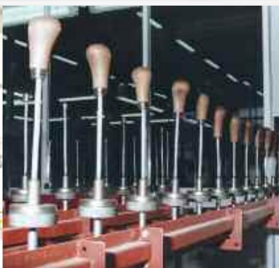
Impianto di verniciatura con vernice liquida per pomoli leva cambio automobile
